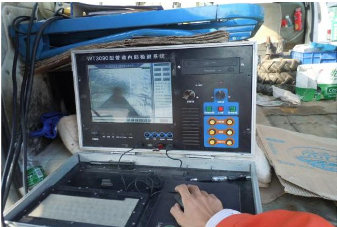
图 8 机器人摄像反馈井下管道情况
