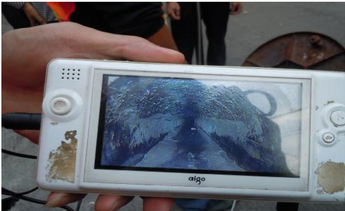
图 4 检测仪器显示管道情况
